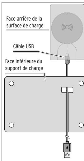
1. Raccordez le support de charge avec le câble USB fourni, comme représenté sur l'illustration. Positionnez le câble USB dans le rail de guidage situé sur la face inférieure du support de charge.
