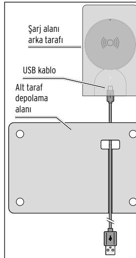
1. Birlikte teslim edilen USB kablosunu resimde gösterildiği gibi şarj alanına bağlayın. USB kablosunu depolama alanının alt tarafındaki kılıvuz rayına yerleştirin.
