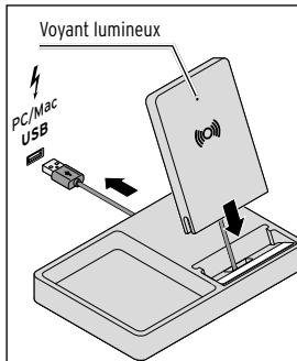
2. Placez la surface de charge, comme représenté sur l'illustration, dans la fente prévue à cet effet dans le support de charge.
